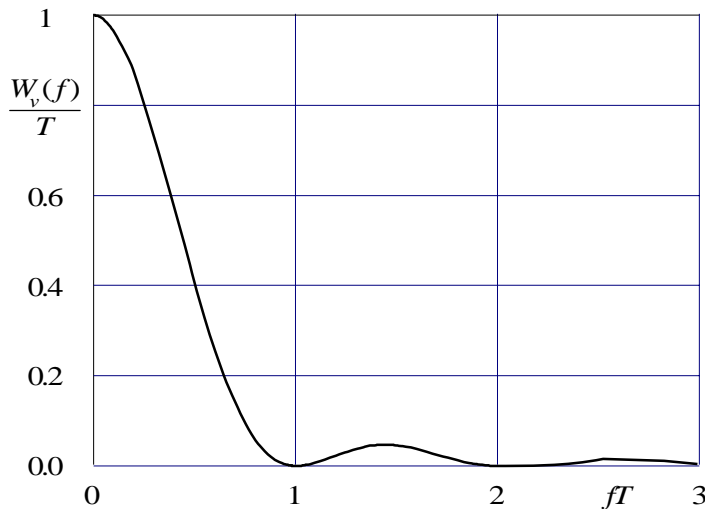
Fig. III.2 - Densità spettrali per modulazione ASK e PSK binari.
